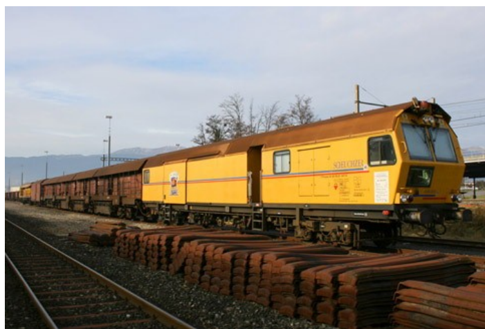
Train meuleur de rails (Scheuchzer S.A.)
